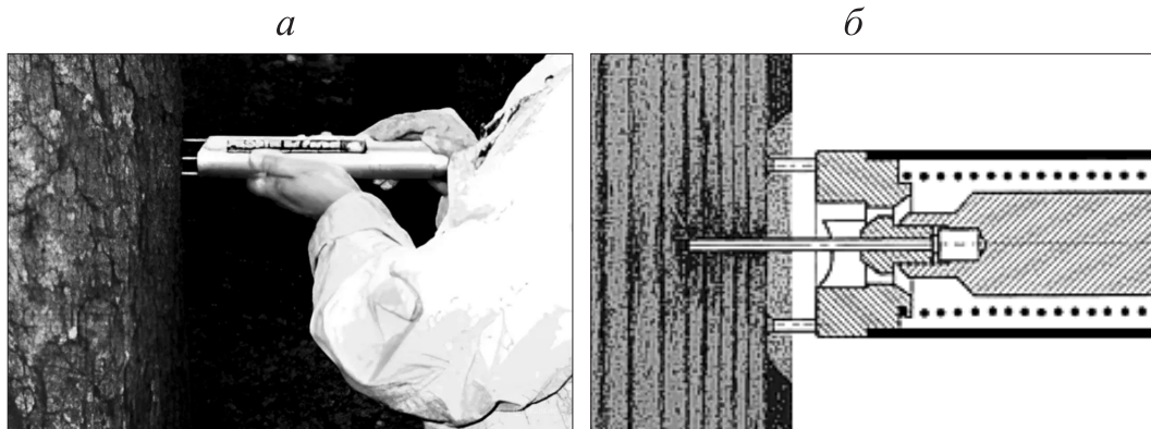
Рис. 1. Принцип работы (а) и схема пилодин-тестера (б).
