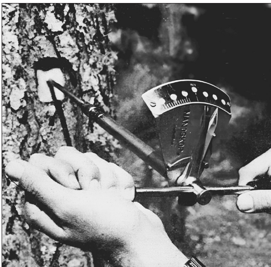
Рис. 4. Торсиометр, прикрепленный к возрастному бурову (Cown, 1978).
